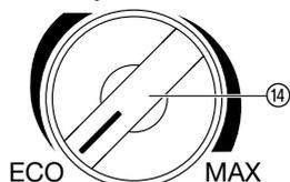
Для экономии энергии (до 15 %) в зависимости от случая применения давление отключения насоса плавно регулируется между **ECO** и **MAX**. (Разница давления между **ECO** и **MAX** составляет ок. 1 бар).
